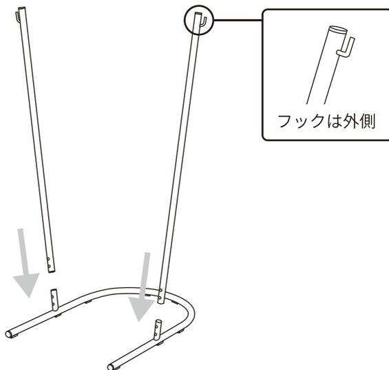
**2** ボルトとワッシャーを取り付け、フレームを固定します。
